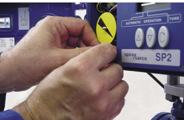
Puesta en marcha de un posicionador, componente del EasiHeat
