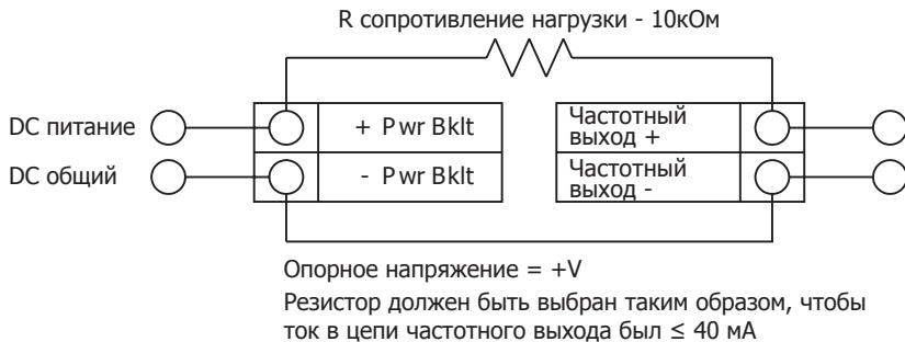
**Рис. 37 Неизолированный от внешнего источника питания частотный выход**
