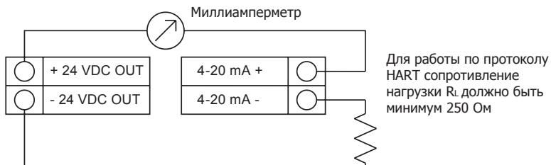
**Рис. 35 Изолированный от внутреннего источника питания выход 4 - 20 мА**
