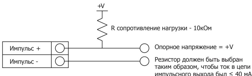
Рис. 22 Изолированный от внешнего источника питания импульсный выход
