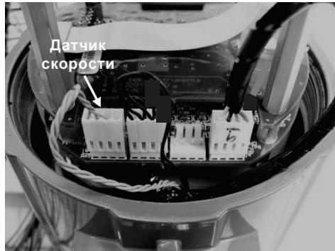
Рис. 51 Входы от датчика скорости при блоке электроники расположеннном на расходомере
