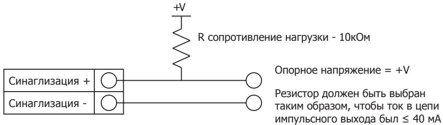
**Рис. 42 Изолированный от внешнего источника питания выход сигнализации**
