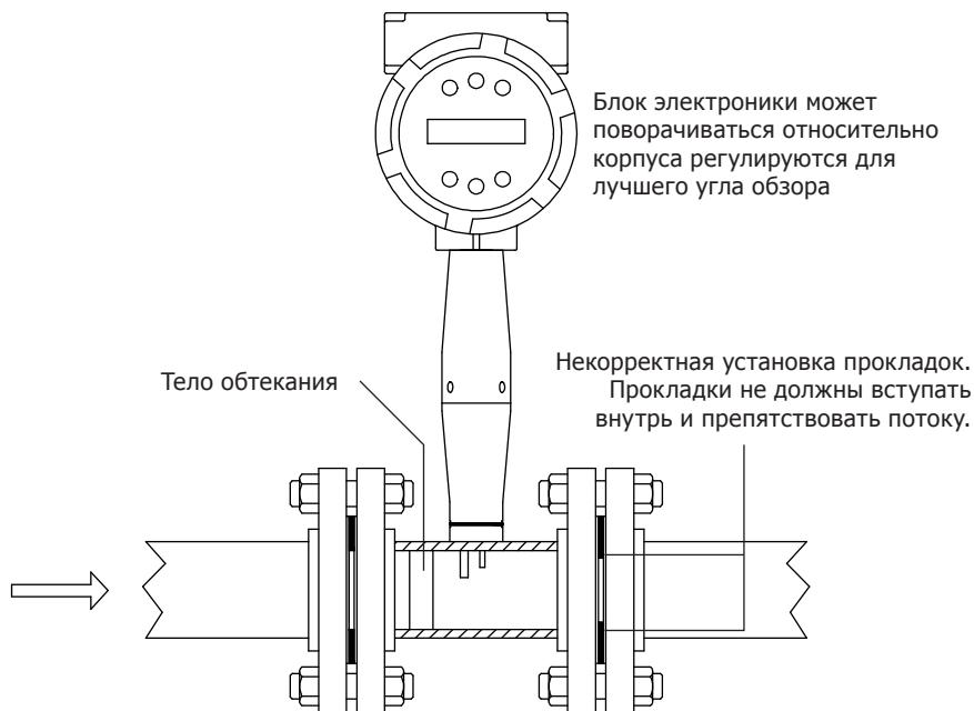
**Рис. 7 Монтаж фланцевого расходомера-счетчика**
