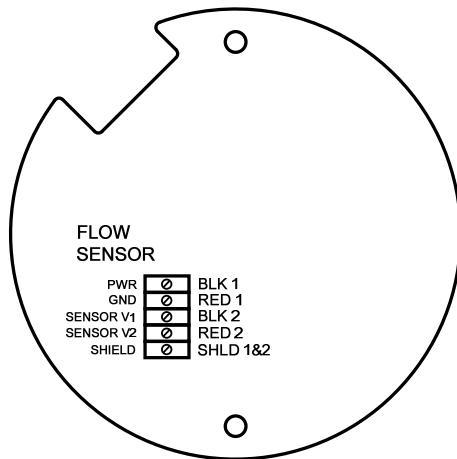
**Рис. 27 Подключение датчика вихрей в распределительной коробке расходомера-счетчика с питанием от токовой петли**
