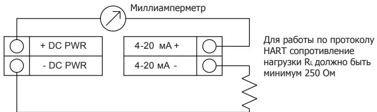
**Рис. 34 Неизолированный от внешнего источника питания выход 4 - 20 мА**
