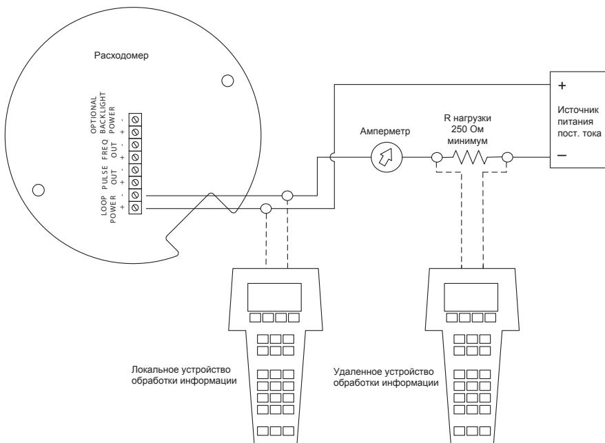
Рис. 47 Подключение к токовой петле (HART)
