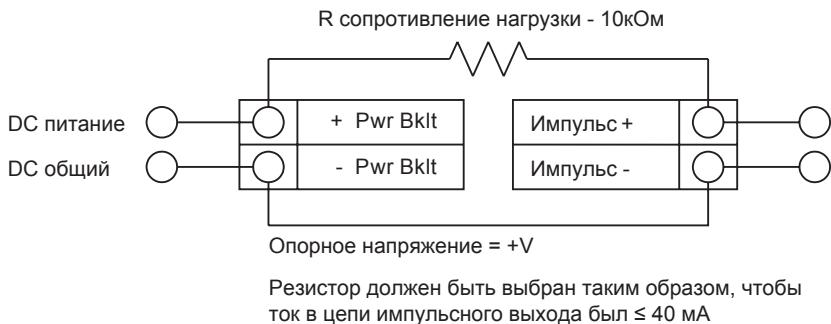
**Рис. 40 Неизолированный от внешнего источника питания импульсный выход**
