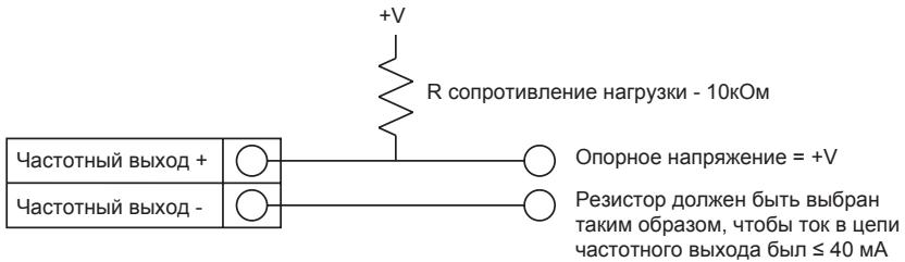
**Рис. 36 Изолированный от внешнего источника питания частотный выход**
