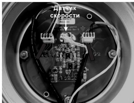
Рис. 52 Входы от датчика скорости при выносном блоке электроники
