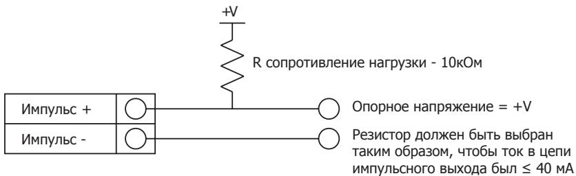
**Рис. 39 Изолированный от внешнего источника питания импульсный выход**
