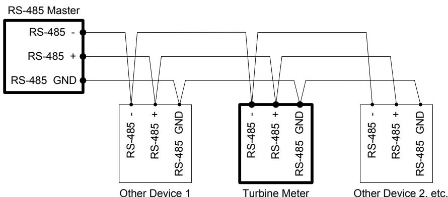
Рис. 50 RS-485 Подключение (MODBUS)
