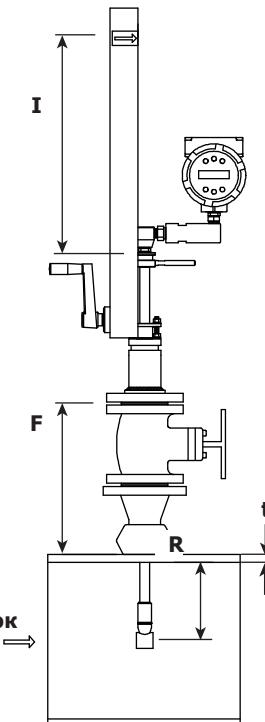
Рис. 13 Расчет глубины погружения расходомера-счетчика с сальниковым уплотнением штанги и ручным
