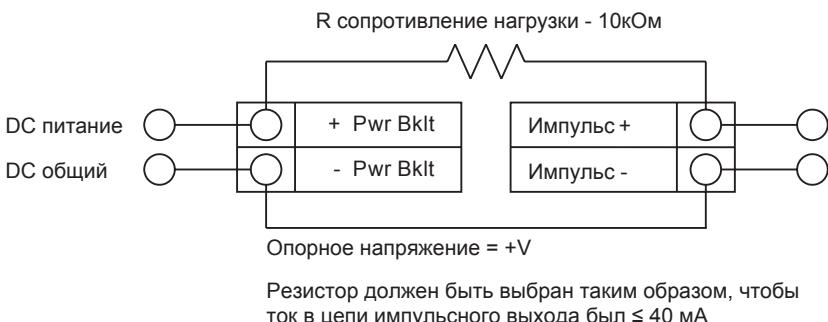
Рис. 23 Неизолированный от внешнего источника питания импульсный выход
