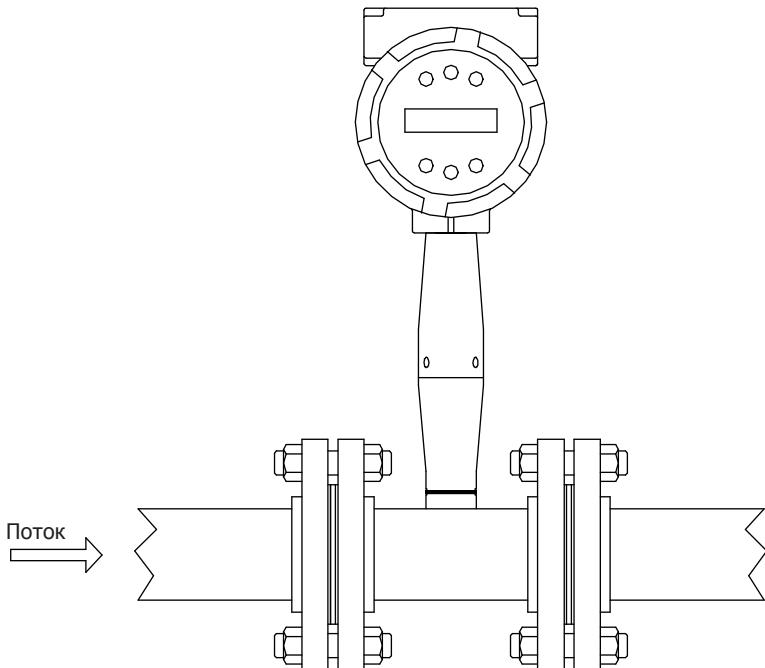
Рис. 1 Корпусной вихревой расходомер-счетчик
