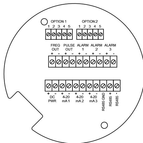
Рис. 30 Клеммы при питании от источника постоянного напряжения (Vdc)
