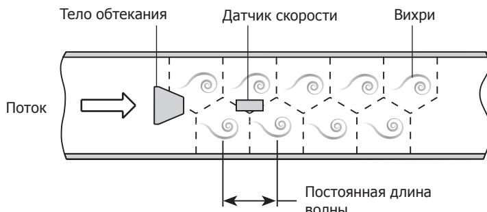
Рис. 2 Принцип работы вихревых расходомеров-счетчиков
