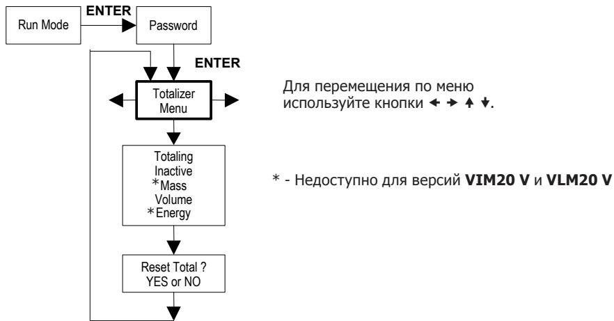
Используйте сумматор 2 для накопления значения объемного расхода. Обратите внимание, что сумматор 2 не привязан к выходному реле и используется только для индикации.
