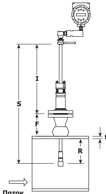
Рис. 16 Расчет глубины погружения
