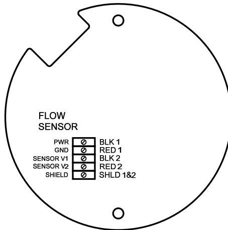
**Рис. 45 Подключение датчика вихрей в распределительной коробке расходомера-счетчика**
