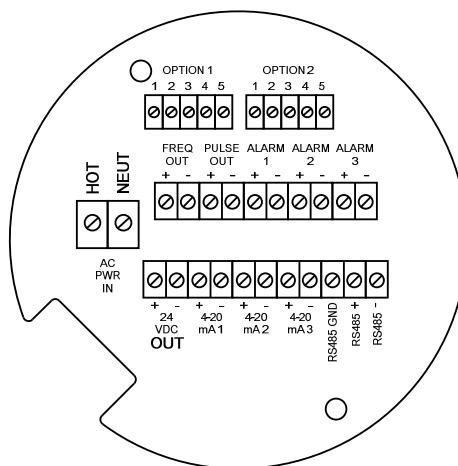
Рис. 28 Клеммы при питании от источника переменного напряжения
