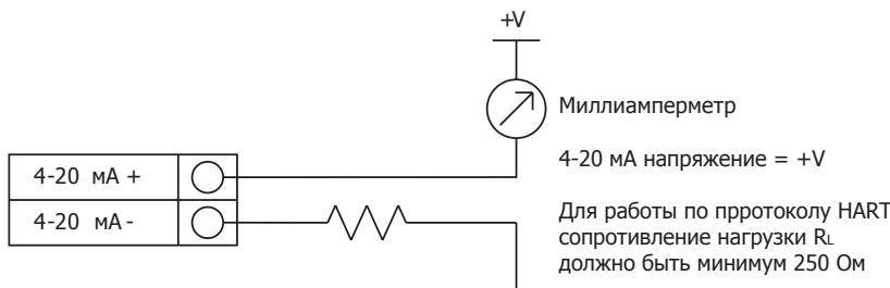
Рис. 33 Изолированный от внешнего источника питания выход 4 - 20 мА
