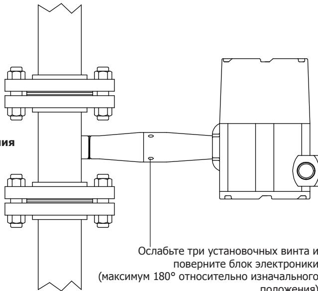
Во избежание повреждения проводов датчика не поворачивайте корпус более чем на 180° от первоначального положения. Чтобы повернуть корпус блока электроники:
