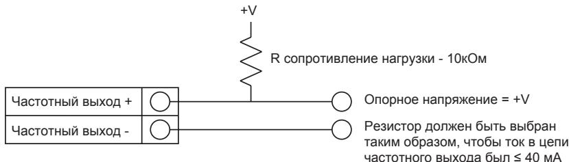
Рис. 24 Изолированный от внешнего источника питания частотный выход
