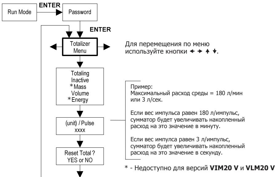
Используйте меню «Сумматор» для настройки и контроля сумматора. Выход сумматора представляет собой положительный импульс длительностью 50 миллисекунд (0,05 секунды) (реле замыкается на 50 миллисекунд). Сумматор не может работать быстрее, чем один импульс каждые 100 миллисекунд (0,1 секунды). Рекомендуется устанавливать единицы на импульс, равные максимальному расходу в одних и тех же единицах в секунду. Это ограничит время между импульсами не чаще, чем один импульс каждую секунду.
