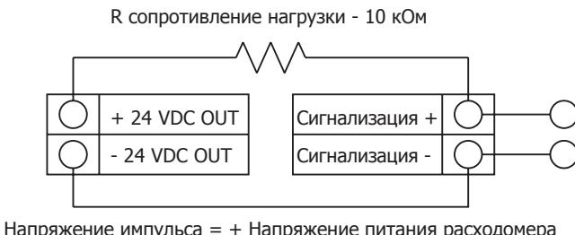
**Рис. 44 Изолированный от внутреннего источника питания выход сигнализации**
