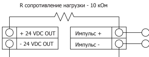
**Рис. 41 Изолированный импульсный выход от внутреннего источника питания**
