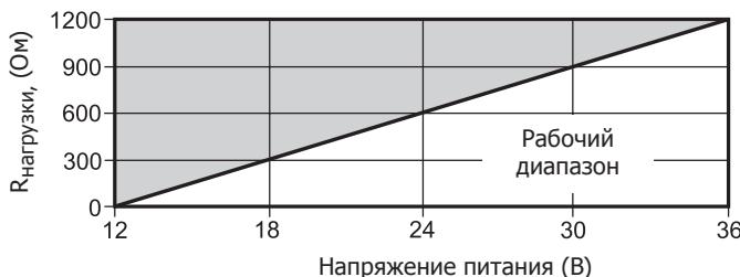
Рис. 32 Сопротивление нагрузки относительно входного напряжения
