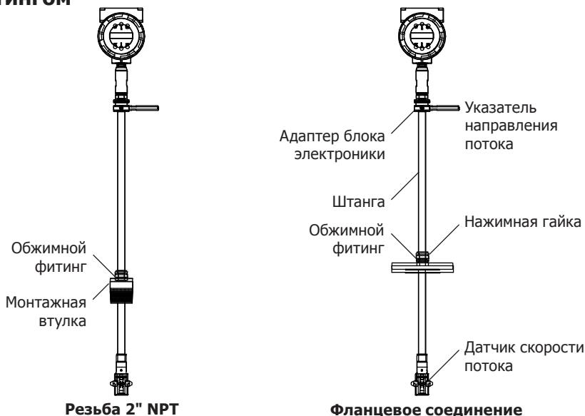
Рис. 12 Монтаж расходомера-счетчика с обжимным фитингом
