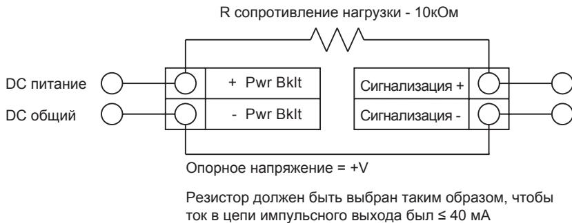
**Рис. 43 Неизолированный от внешнего источника питания выход сигнализации**
