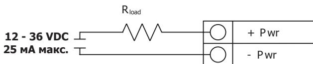
Рис. 20 Подключение источника постоянного тока
