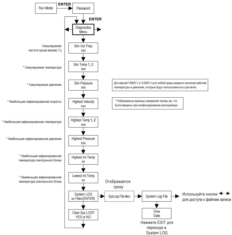
Для версий **VIM20 V** и **VLM20 V** работающих на любой жидкости, введите номинальную рабочую температуру и давление как смоделированные значения в меню диагностики.
