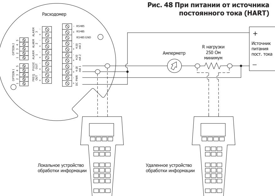
Рис. 48 При питании от источника постоянного тока (HART)
