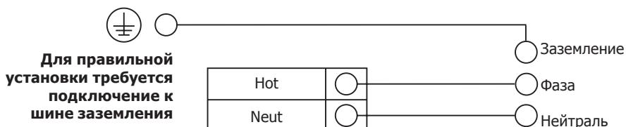
Рис. 29 Подключение источника питания переменного тока (VAC)
