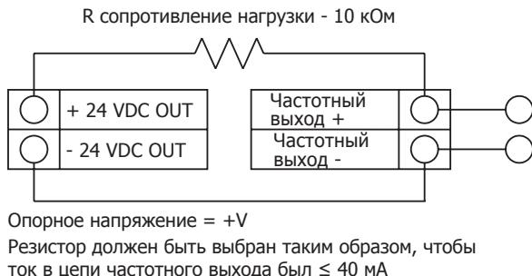
**Рис. 38 Изолированный от внутреннего источника питания частотный выход**
