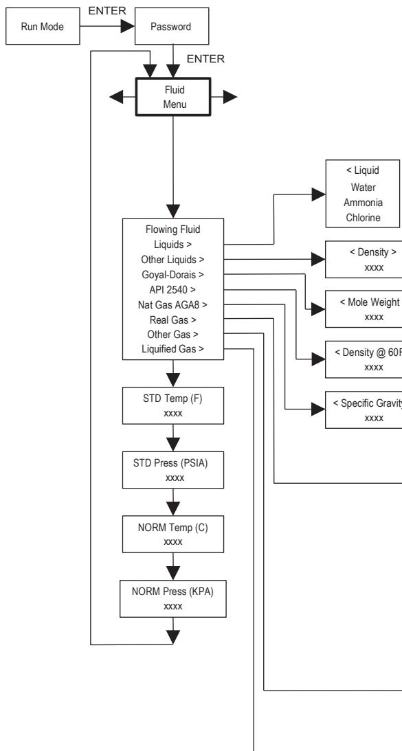
Используйте Fluid Menu для конфигурирования расходомера, применяемого на обычных газах, жидкостях и паре. Ваш расходомер предварительно запрограммирован на заводе под ваши параметры.
