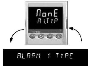
В нижней части – схематическое обозначение параметра и более полное в бегущей строке.
