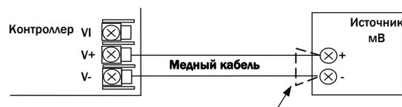
Рис. 1: Соединение с источником мВ сигнала
