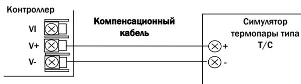
Рис 2: Соединение с симулятором термопары
