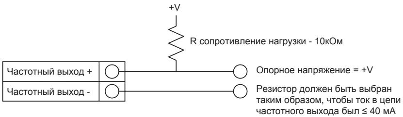
**Рис. 29 Изолированный от внешнего источника питания частотный выход**
