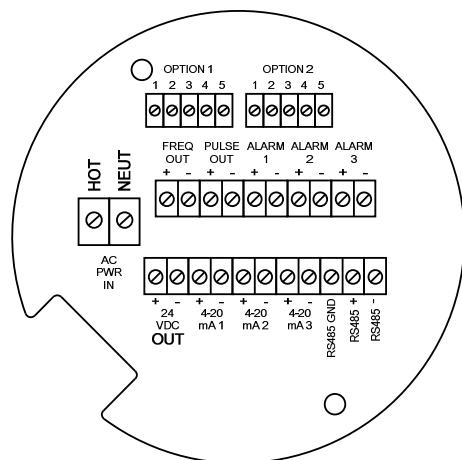
Рис. 21 Клеммы при питании от источника переменного напряжения
