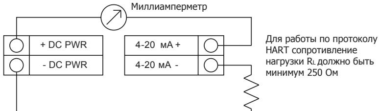
Рис. 27 Неизолированный от внешнего источника питания выход 4 - 20 мА
