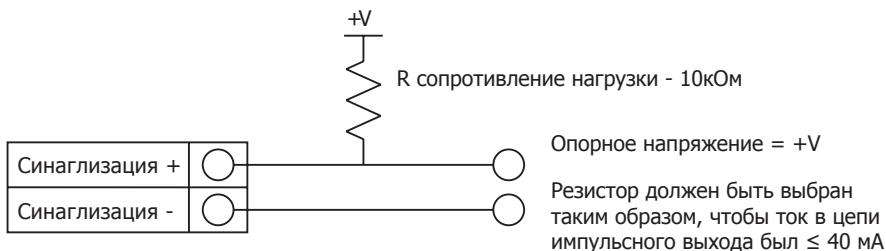
**Рис. 35 Изолированный от внешнего источника питания выход сигнализации**
