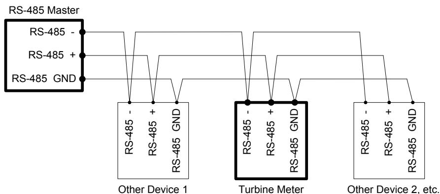
Рис. 44 RS-485 Подключение (MODBUS)
