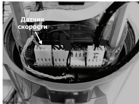
**Рис. 43 Входы от датчика скорости при блоке электроники расположеннном на расходомере-счетчике**
