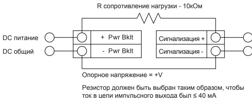
**Рис. 36 Неизолированный от внешнего источника питания выход сигнализации**
