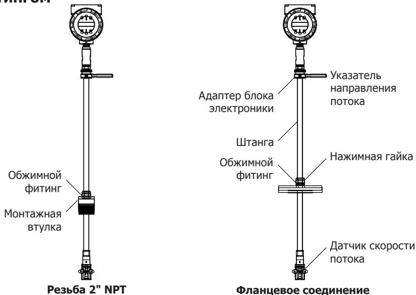
Рис. 7 Монтаж расходомера-счетчика с обжимным фитингом
