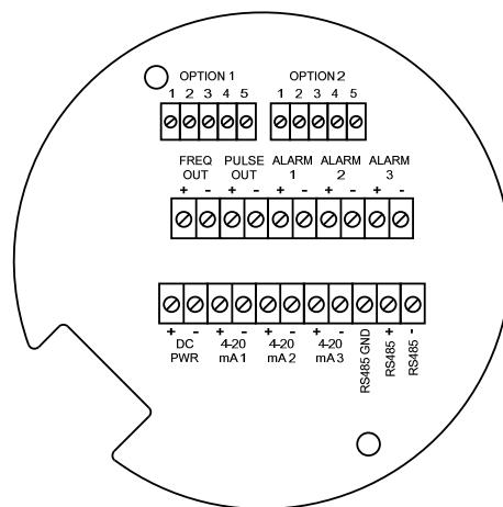
Рис. 23 Клеммы при питании от источника постоянного напряжения
