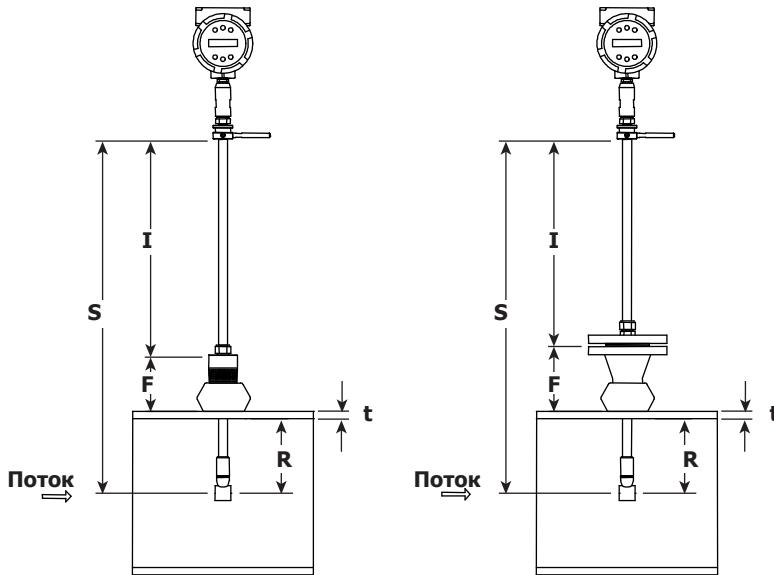
**Рис. 6 Расчет глубины погружения (обжимной фитинг)**
