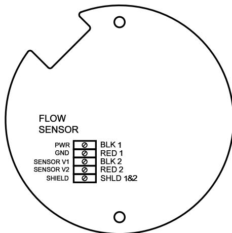
**Рис. 20 Подключение датчика расхода в распределительной коробке расходомера-счетчика с питанием от токовой петли**
