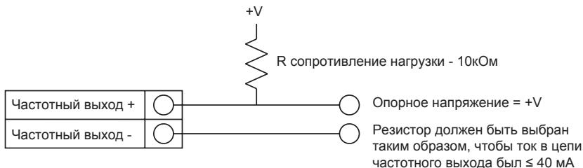
Рис 18 Изолированный от внешнего источника питания частотный выход
