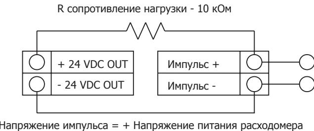
**Рис. 34 Изолированный импульсный выход от внутреннего источника питания**
