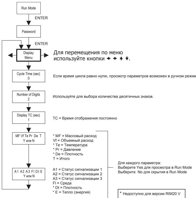
Используйте Display Menu, чтобы установить время цикла для автоматической последовательности экранов, используемое в рабочем режиме (Run Mode), изменить точность отображаемых значений, время переходов, а также включить или отключить каждый элемент, отображаемый на экранах рабочего режима (Run Mode).
