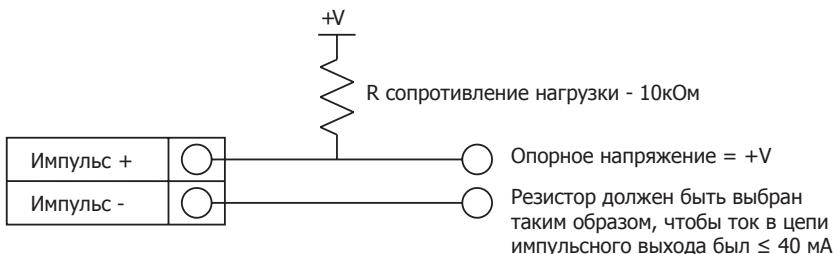
Рис. 16 Изолированный от внешнего источника питания импульсный выход
