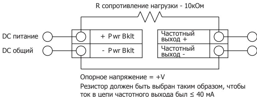
**Рис. 30 Неизолированный от внешнего источника питания частотный выход**
