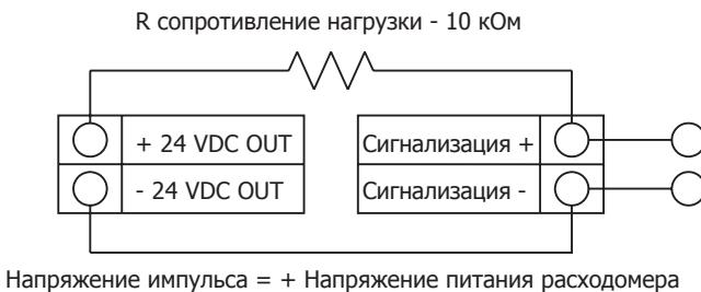
**Рис. 37 Изолированный от внутреннего источника питания выход сигнализации**
