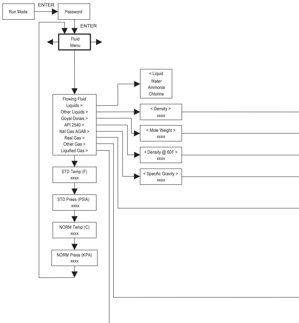
Используйте Fluid Menu для конфигурирования расходомера, применяемого на обычных газах, жидкостях и паре. Ваш расходомер-счетчик предварительно запрограммирован на заводе под ваши параметры.
