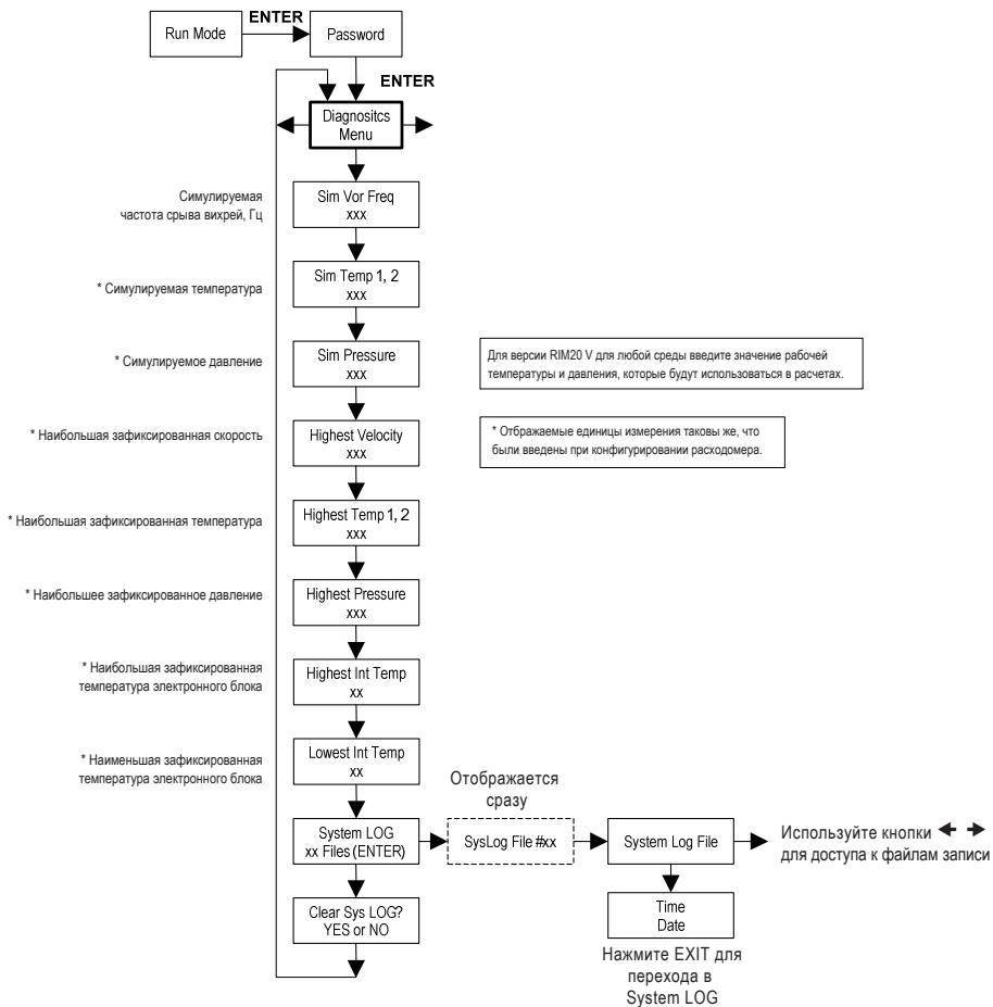
Для версии расходомера-счетчика **RIM20 V** работающем на любой жидкости, введите номинальную рабочую температуру и давление как смоделированные значения в меню диагностики.
