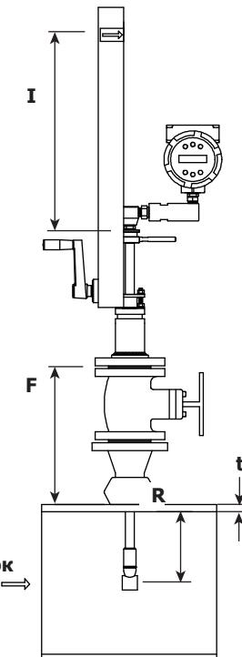
**Рис. 8 Расчет глубины погружения расходомера-счетчика с сальниковым уплотнением штанги и ручным**
