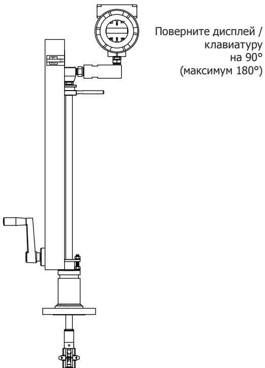
Рис. 12 Ориентация дисплея / клавиатуры
