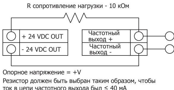
**Рис. 31 Изолированный от внутреннего источника питания частотный выход**
