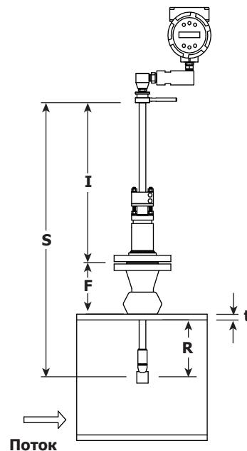
Рис. 11 Расчет глубины погружения
