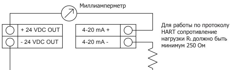
Рис. 28 Изолированный от внутреннего источника питания выход 4 - 20 мА
