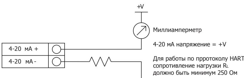
Рис. 26 Изолированный от внешнего источника питания выход 4 - 20 мА
