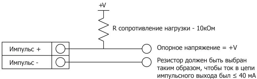
**Рис. 32 Изолированный от внешнего источника питания импульсный выход**
