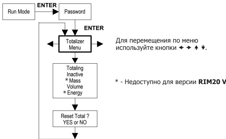
Используйте сумматор 2 для накопления значения объемного расхода. Обратите внимание, что сумматор 2 не привязан к выходному реле и используется только для индикации.
