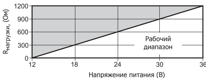
Рис. 25 Сопротивление нагрузки относительно входного напряжения
