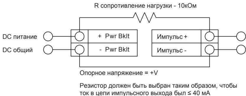
**Рис. 33 Неизолированный от внешнего источника питания импульсный выход**
