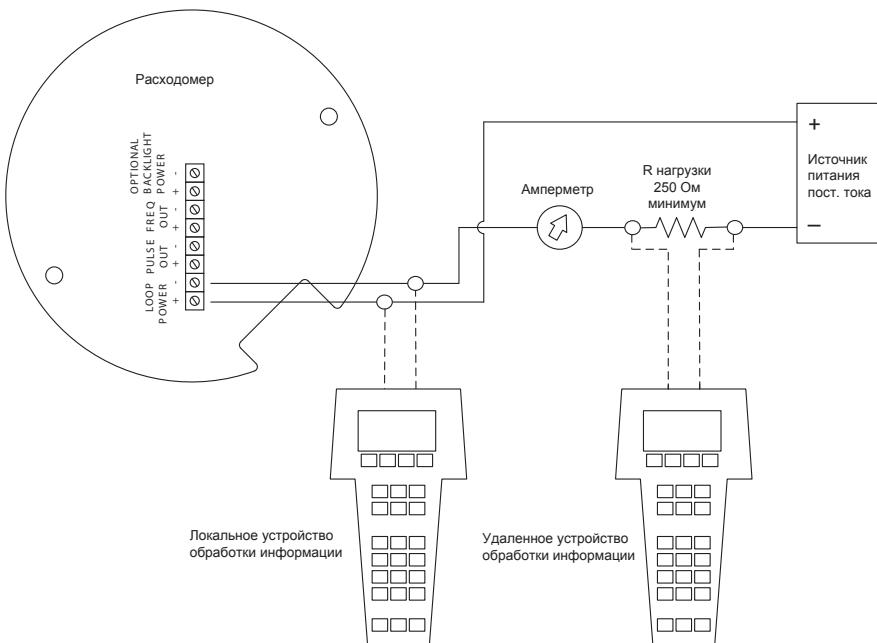
Рис. 40 Подключение к токовой петле (HART)
