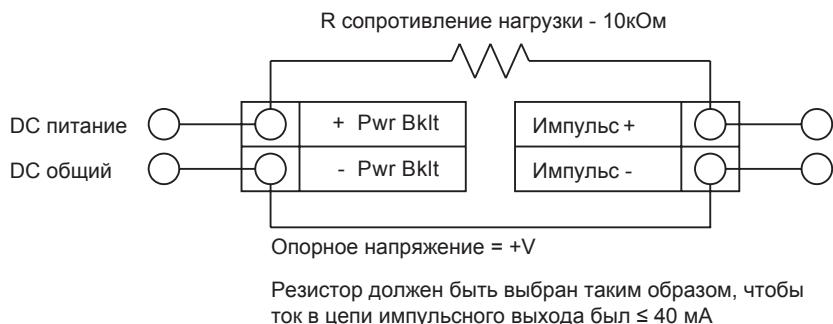
Рис. 17 Неизолированный от внешнего источника питания импульсный выход
