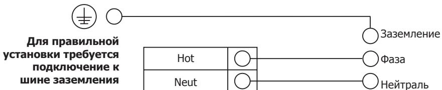
Рис. 22 Подключение источника питания
