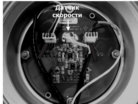
**Рис. 44 Входы от датчика скорости при выносном блоке электроники**
