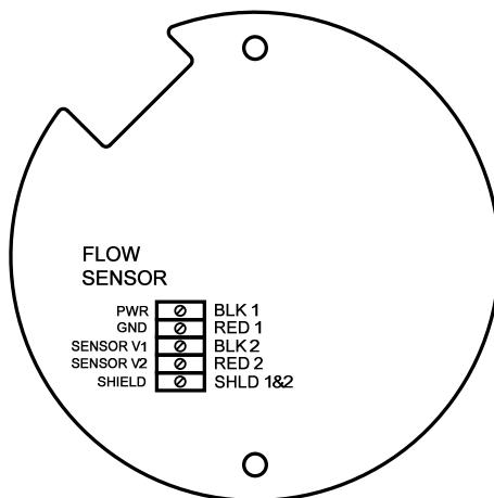
**Рис. 38 Подключение датчика расхода в распределительной коробке расходомера-счетчика**
