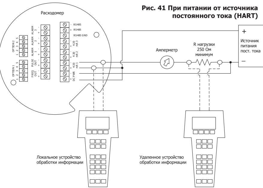
Рис. 41 При питании от источника постоянного тока (HART)
