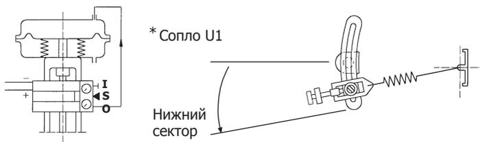
Рис. 8с Обратное действие и нормально закрытый клапан
