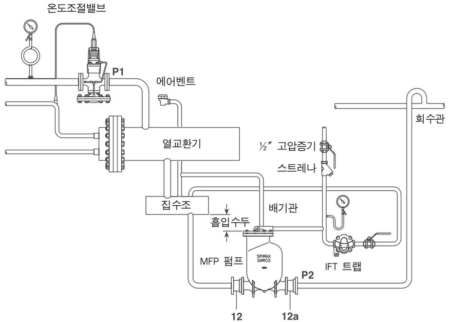
그림 4. 저압 열교환기의 응축수를 고가배관으로 회수 - 배압 P<sub>2</sub>가 열교환기 입구압력 P<sub>1</sub>보다 높음
