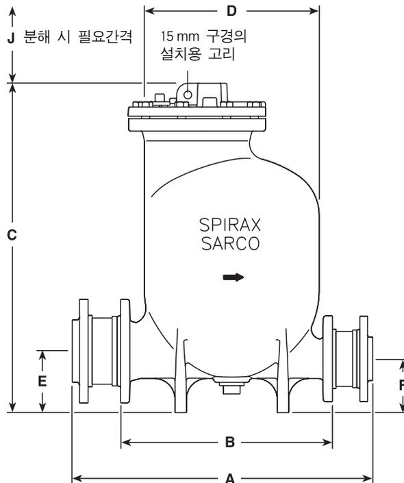
그림 2. DN80 × DN50 MFP14
