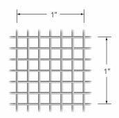
Esempio di schermatura di filtraggio a 6 mesh
