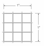
Esempio di schermatura di filtraggio a 3 mesh
