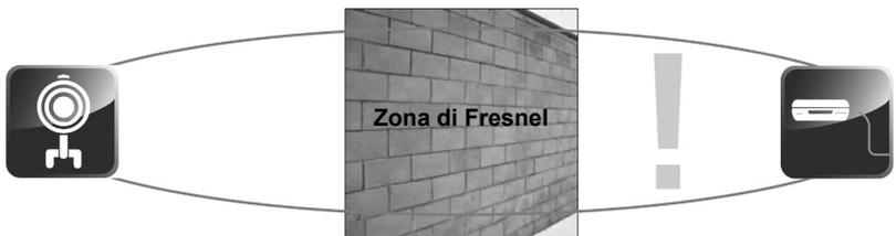
**Fig. 6 - Zona di Fresnel bloccata (ostacolata) - Sistemazione errata**
