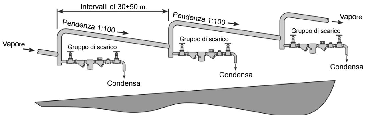
**Esempi di esecuzioni corrette (✓) ed errate (X) sulle linee vapore:**
