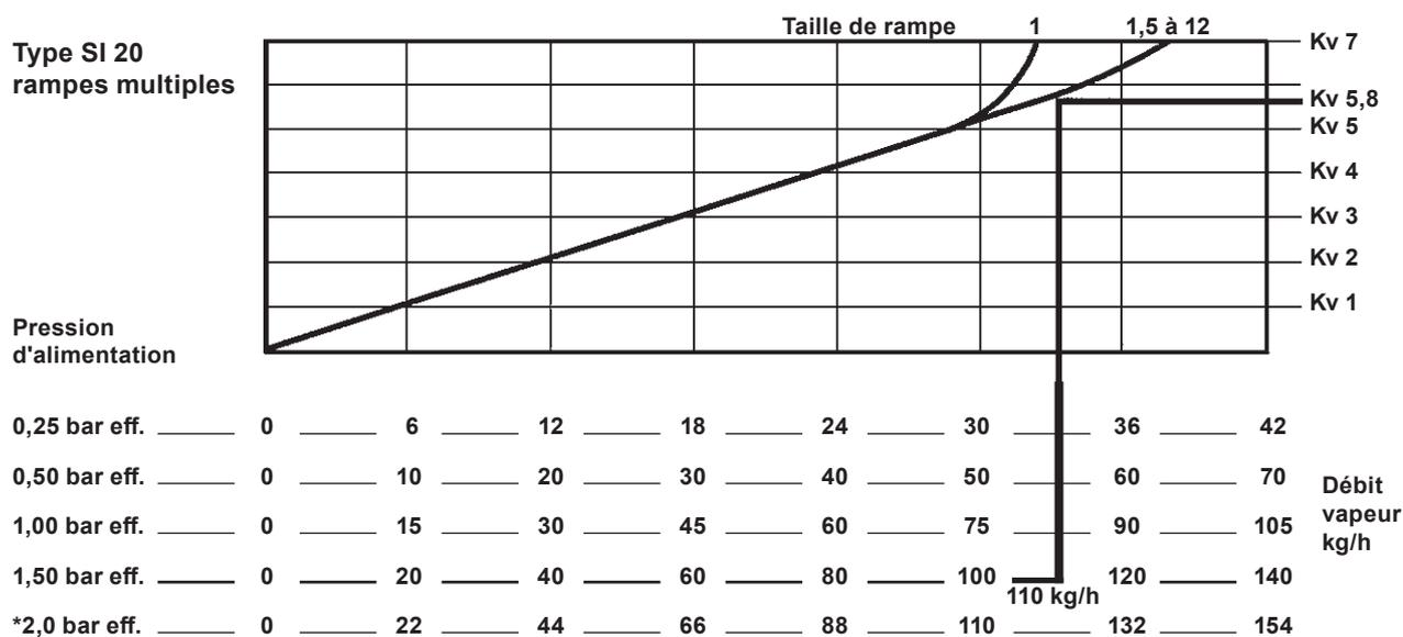
\*Pression d'alimentation recommandée au séparateur pour un fonctionnement correct de l'humidificateur. Pour des pressions de fonctionnement au-dessus de 2 bar eff., contacter Spirax Sarco.
