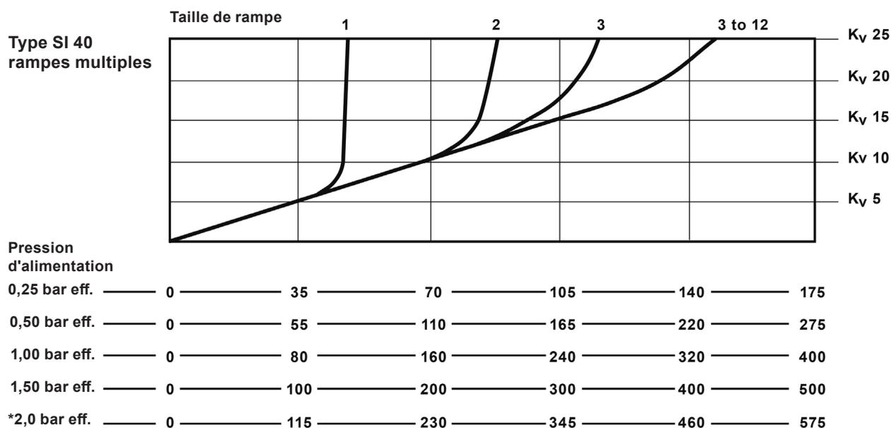
**Nota :** la pression d'alimentation maximale recommandée au séparateur SI est de 2 bar eff. pour un fonctionnement correct de l'humidificateur. Pour des pressions de fonctionnement supérieures, contacter Spirax Sarco.
