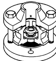
\*Nota : les brides, les boulons (ou écrous), les vis et les joints sont fournis par l'installateur. Le clapet de retenue est indémontable (aucune pièce de rechange est disponible) et il ne convient pas sur des circuits où le débit est soumis à de fortes pulsations (proximité d'un compresseur).
