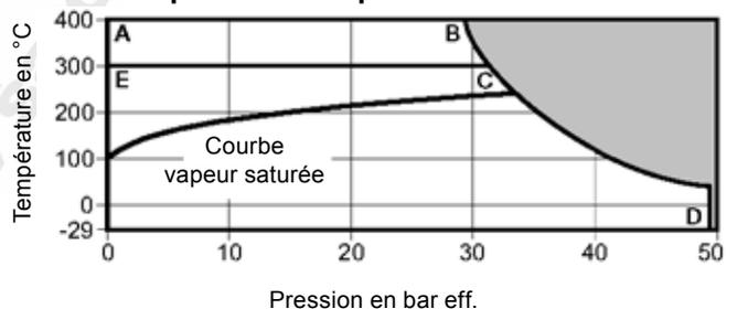
Cet appareil ne doit pas être utilisé dans la zone ombrée.
