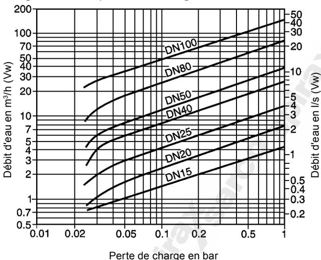
Diagramme de perte de charge avec disque ouvert et de l'eau à 20°C. Les valeurs données sont valables pour des clapets équipés de ressorts avec un sens d'écoulement horizontal.
