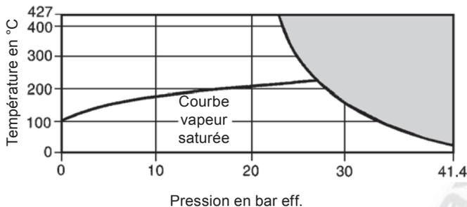
Cet appareil ne doit pas être utilisé dans la zone ombrée.
