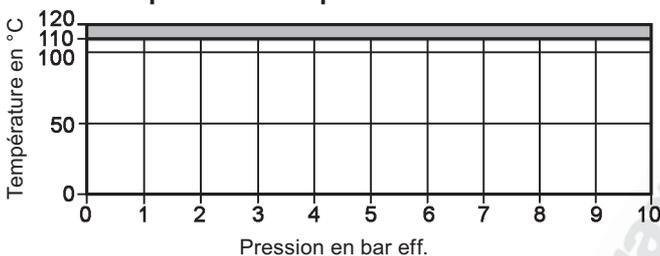
Cet appareil ne doit pas être utilisé dans la zone ombrée car cela risque d'endommager les pièces internes.
