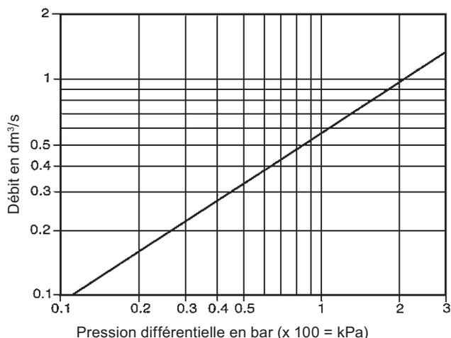
Si la température de l'air diffère de 16°C, les débits de la courbe peuvent être corrigés en les multipliant par :
