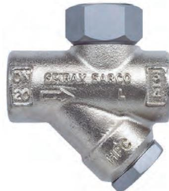
Ils peuvent être raccordés à l'un des systèmes de contrôle de purgeur "Spiratec". La surface extérieure du corps des purgeurs a subi un nickelage chimique (ENP) afin d'améliorer sa résistance à la corrosion. Ils sont fixés avec deux vis sur un connecteur en acier inox afin de faciliter l'entretien. Ces purgeurs peuvent être retirés/remplacés en utilisant une simple clé dans un minimum de temps.
