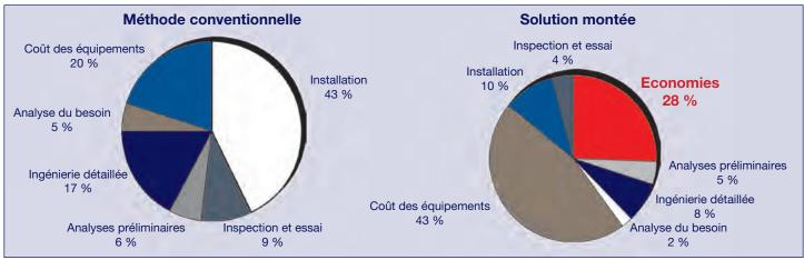
Comparé à une solution monté sur site, avec des composants de divers origine, un système pré-monté apporte un gain significatif de temps et d'argent.
