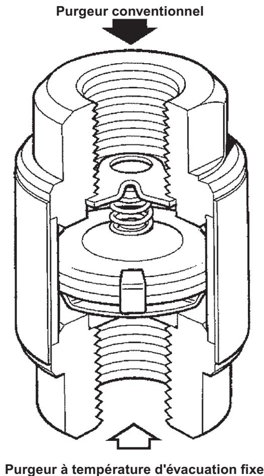
Fig. 1 Indique le sens du fluide à travers le purgeur lorsqu'il est utilisé sur une application type
