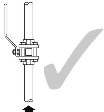
**Fig. 2 - Installation correcte pour les applications gaz**
