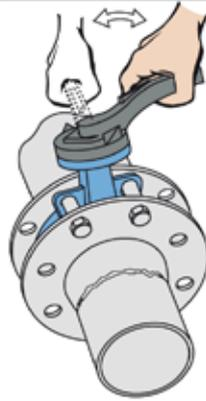
Klappenscheibe öffnen und prüfen, ob diese frei beweglich ist. Klappenscheibe leicht geöffnet lassen.
