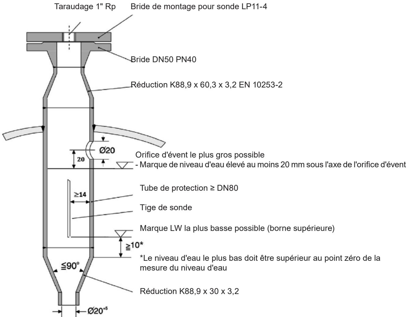
Fig. 2 - Exemple d'installation 1 : À l'intérieur de la chaudière avec un tube de protection fourni par le client
