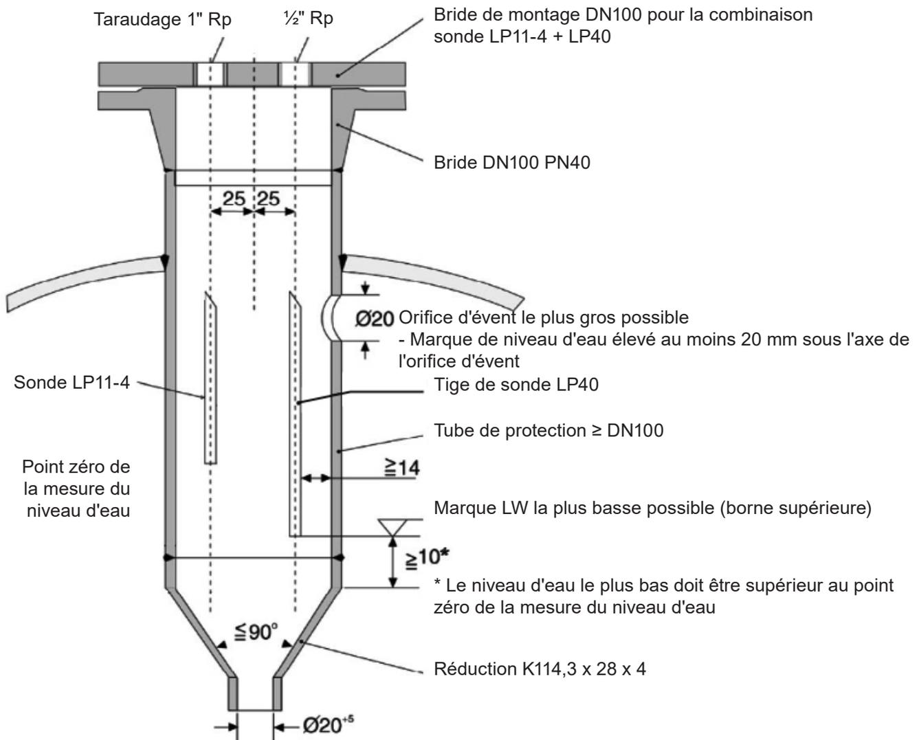
**Fig. 3 - Exemple d'installation 2 : Combinaison avec sonde limiteur de niveau d'eau LP40**
