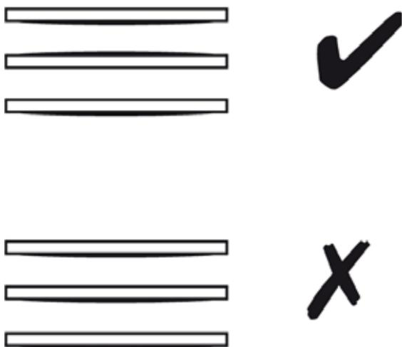
Fig. 3 - Assemblage des rondelles ressorts
