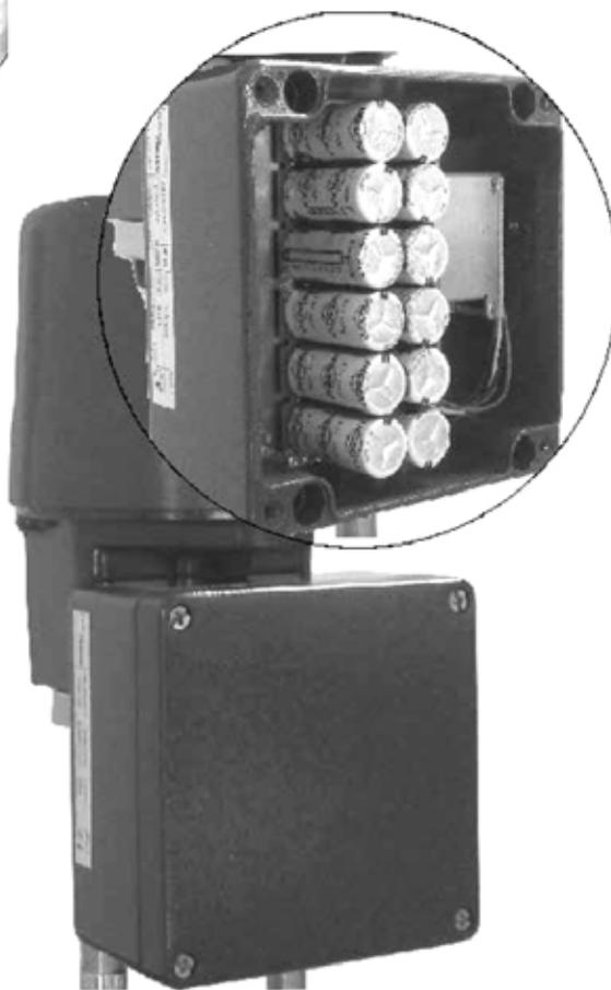
**Fig. 15 - Super-condensateur externe pour les actionneurs suivants :
