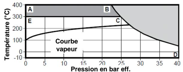
**A – B – D** avec ressort à haute température ou sans ressort
