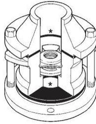
'Les cames' sur le corps du clapet permettent l'adaptation de différents types de brides. Le clapet est tourné pour venir en contact avec les boulons des brides, assurant un centrage sur la tuyauterie.
