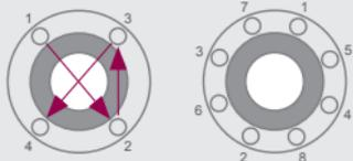
Les boulons de brides doivent être serrés progressivement en croix pour assurer l'alignement et une charge uniforme.
