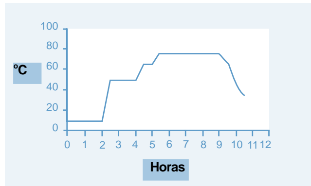
Perfil típico de los distintos cambios de temperatura en la cuba de macerado
