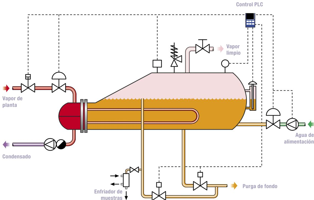
A través de un serpentín con vapor de planta se calienta el agua de alimentación tratada. Se evapora el agua de alimentación produciendo vapor limpio en el secundario.
