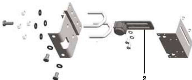
Fig. 17 Kit para montaje a un actuador lineal
