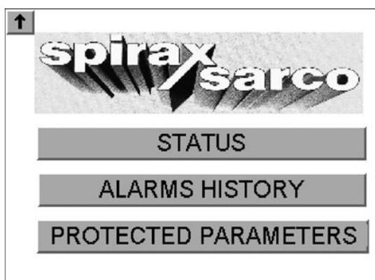
12. Pulsar el botón status, como se muestra a continuación, en el generador, comprobar que el estado que muestra para generador y tranque está en "Stopped" (parado). Reescribir en la pantalla táctil "tank stopped".
