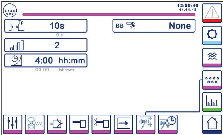
Fig. 39 Bottom blowdown valve parameters
