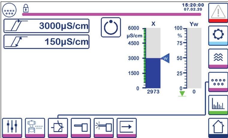
Fig. 31 ON/OFF control parameters
