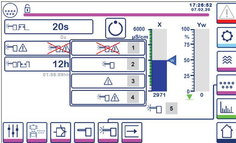
Fig. 37 Probe cleaning parameters
