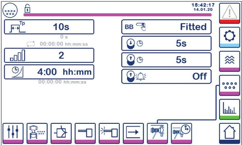
Fig. 40 Bottom blowdown limit switch parameters
