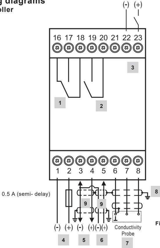
Fig. 11 Wiring Diagram
