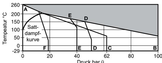
In diesem Bereich darf das Ventil nicht eingesetzt werden.
