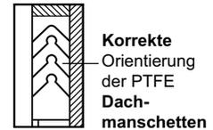
**Hinweis:** die unterste Führungsbuchse wird mit der Rundung nach unten eingesetzt. Die Dachmanschetten werden eine nach der anderen eingesetzt. Diesen Vorgang wiederholen, bis alle erforderlichen Komponenten eingebaut worden sind.
