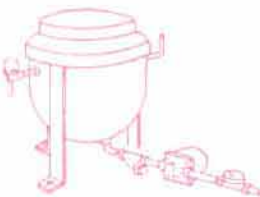
스팀자켓에 자동에어벤트 배관실에 증기입구에서 가장 먼 부분에 설치
