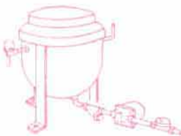
스팀자켓에 자동에어벤트 배관실에 증기압구에서 가장 먼 부분에 설치
