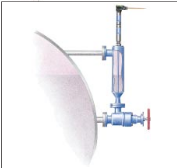
感应探头安装于斯派莎克C2炉 侧感应室带顺序排放阀
