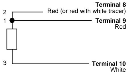
Fig. 23 CP32 probe wiring
